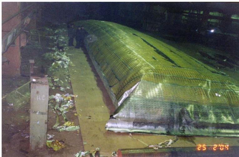
Рис. 1. Пневматические испытания гибкой дамбы в производственном цехе фирмы ООО «Рассвет-К»
