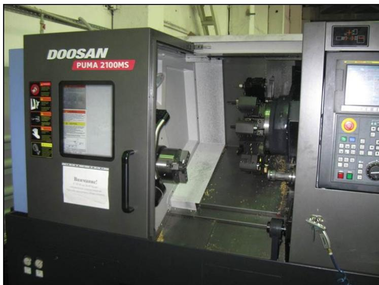
Рис. 2. Высокоскоростной двухшпиндельный токарный обрабатывающий центр PUMA 2100MS с приводным фрезерным инструментом и контр-шпинделем (“DOOSAN”)
