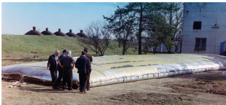
Рис. 2. Промышленные испытания гибкой дамбы в г. Крымске Краснодарского края
