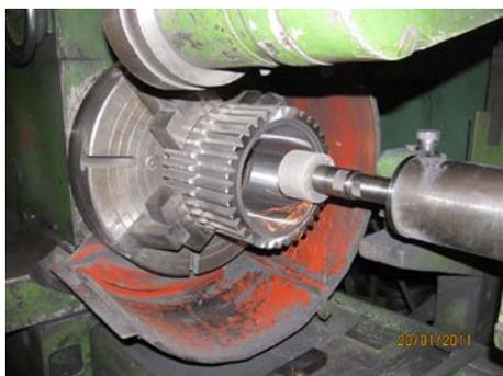
Рис. 2. Шлифование сателлита на внутришлифовальном станке мод. 3К228А.
