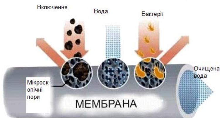
Рис. 1. Принцип роботи ультрафільтрації
