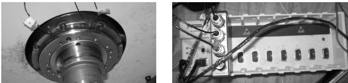
Рис. 1. Установка вибродатчиков AP 2019 на неподвижном торце шпиндельного узла станка мод.500V/5 (слева) и их подключение к многоканальному шасси NI cDAQ-9172 (справа)
