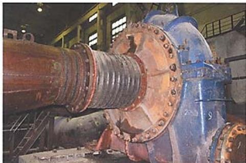
Рис. 1. Испытания напорно-всасывающего патрубка диаметром 800 мм
