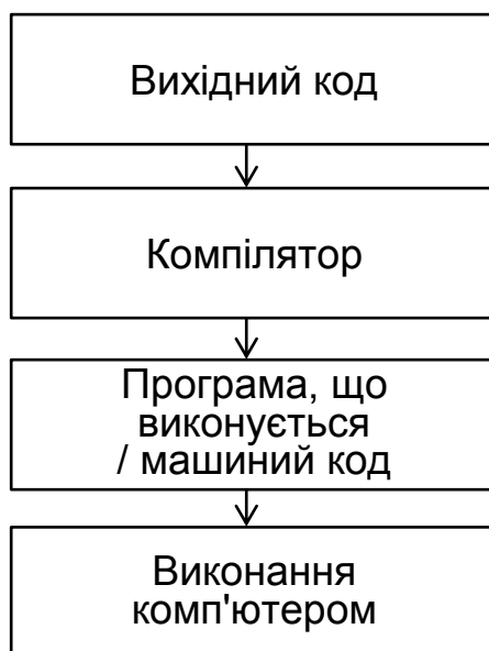
Рис. 1. Традиційний процес компіляції
