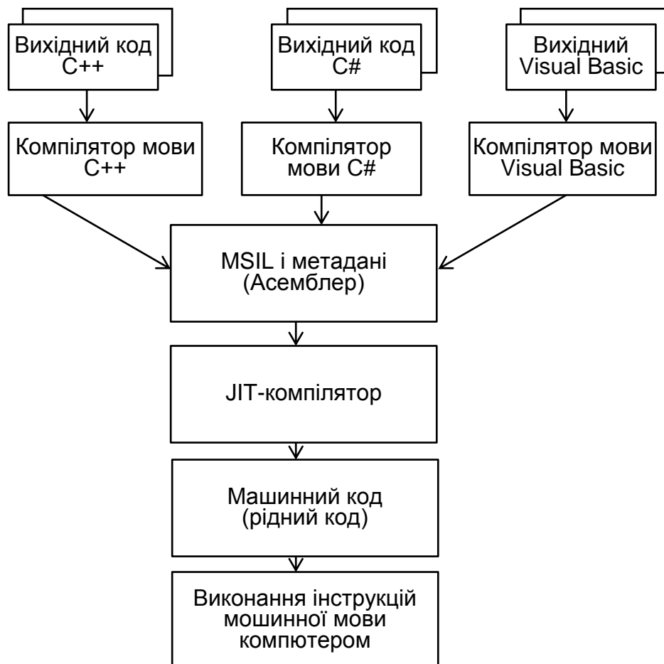
Рис. 2. Процес компіляції в .NET
