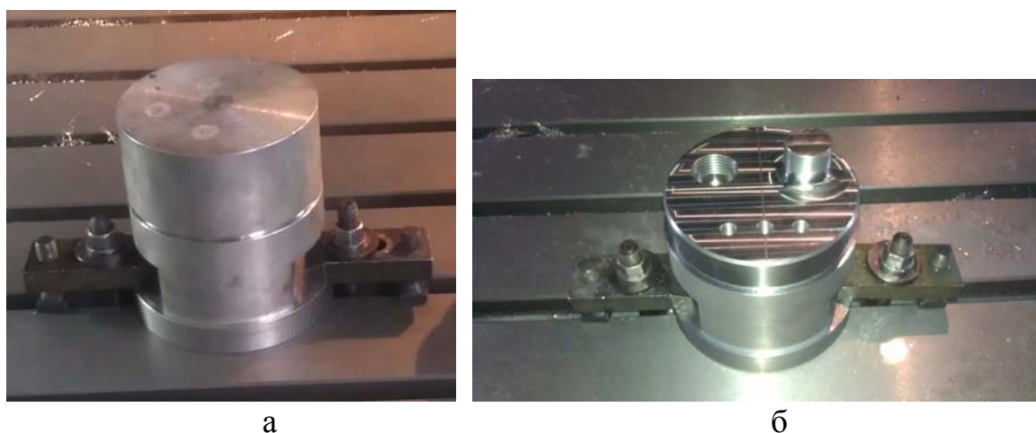
Рис. 12. Фотографии заготовки (а) и детали “цилиндр” (б)
