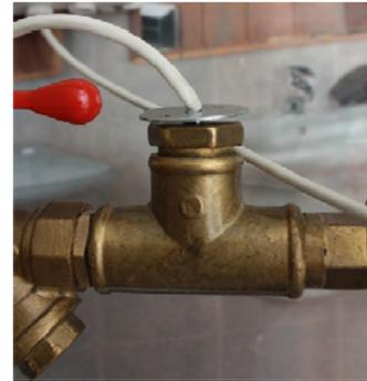
Рис. 2. Цифровий датчик температури DT05 в захисній гільзі
