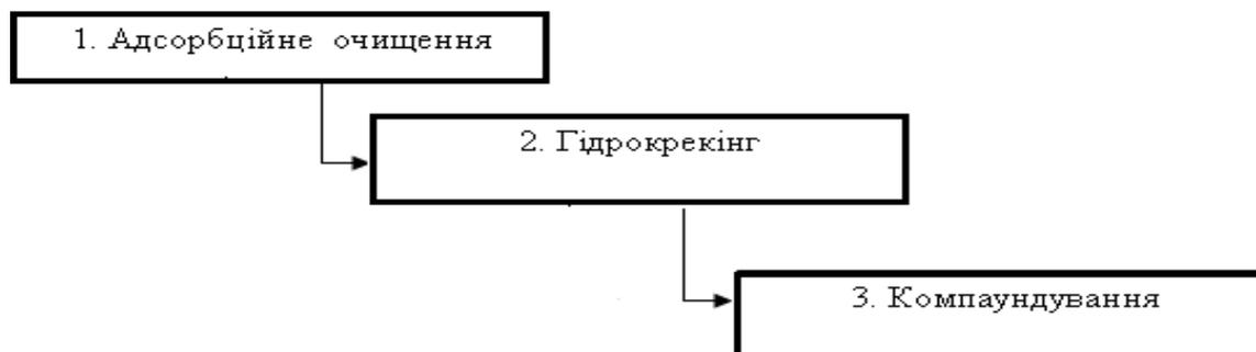
Рис. 1. Загальна схема виготовлення моторного масла ТОВ «ХАДО»
