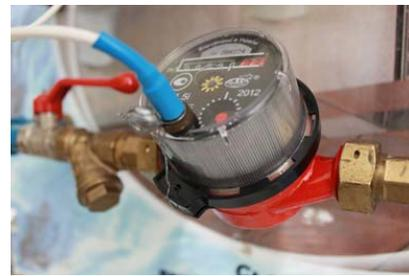
Рис. 4. Перетворювач витрати – ПРХ для установки на трубопроводі холодного водопостачання (за замовленням)
