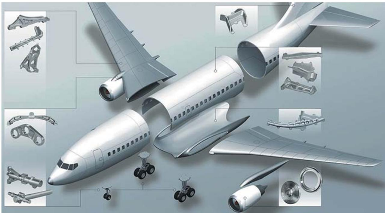
Рис. 1. Детали и узлы самолета, подвергаемые механической обработке
