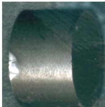
Рис. 8. Критический износ круглой пластины
