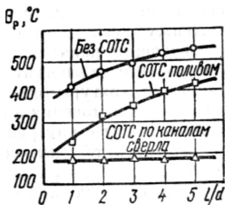
Рис. 4.10. Влияние глубины отверстия и способа подвода СОТС на температуру резания.
