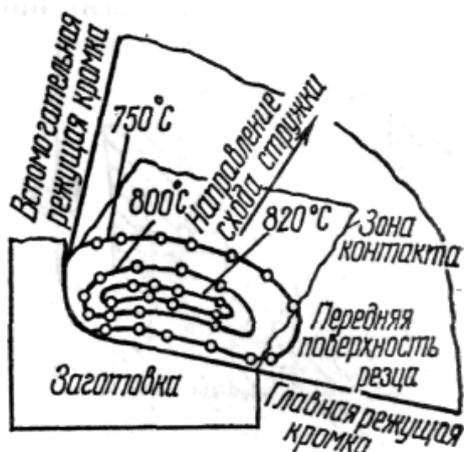
Рис. 4.39. Распределение температуры по передней поверхности резца.
