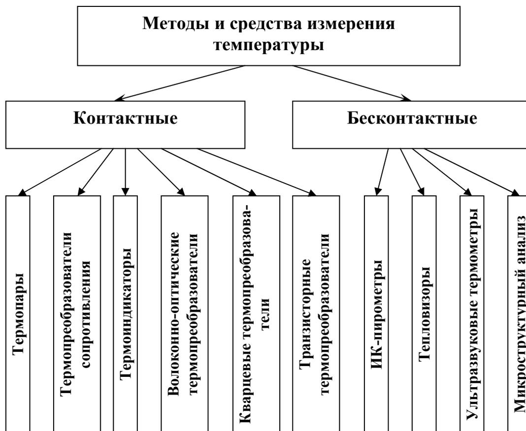
Рис. 4.35. Классификация методов и средств измерения температуры.
