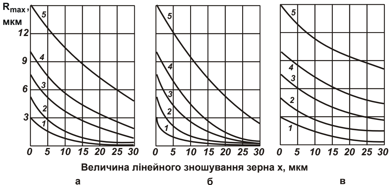
Рис. 4.20. Залежності параметра шорсткості R_{max} від величини лінійного зношування зерна x
