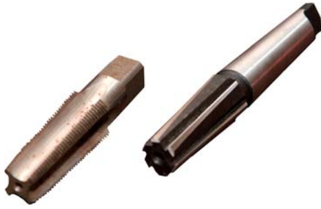
Рис. 3.92. Конічний зенкер і мітчик W27,8 мм
