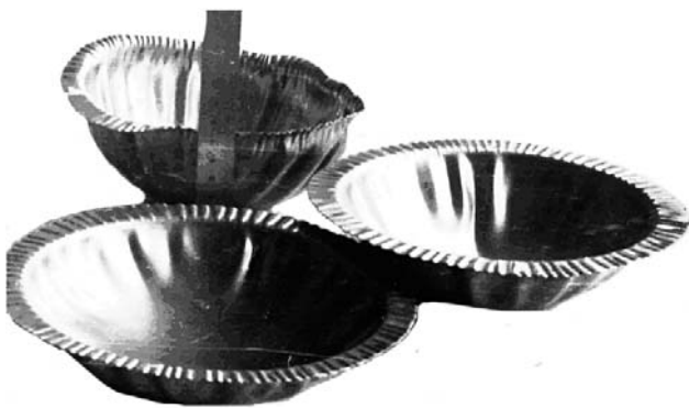
Рис. 1.41. Вплив радіуса закруглення матричних кілець на ступінь витяжки фланця і геометрію гофрів
