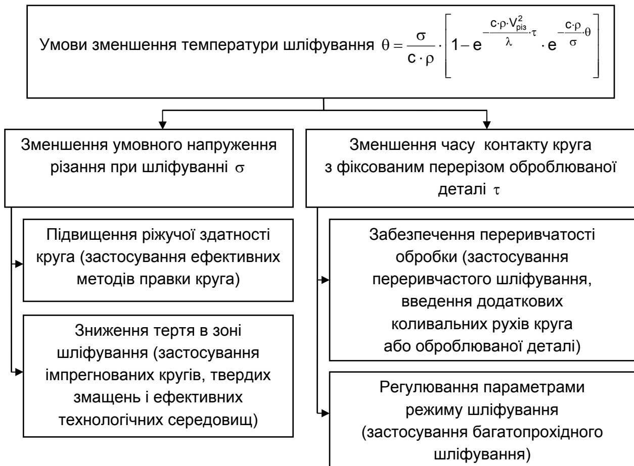
Рис. 3.34. Умови зменшення температури шліфування
