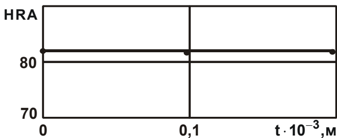
Рис. 3.45. Залежність твердості HRA обробленої деталі від глибини різання t
