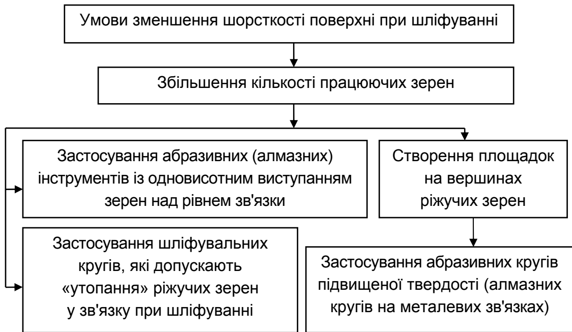
Рис. 3.60. Структурна схема умов зменшення шорсткості поверхні при шліфуванні
