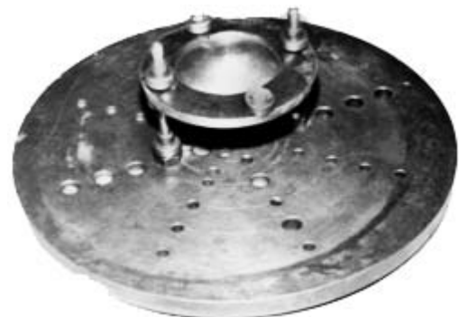
Рис. 1.27. Оснащення з екраном – лінзою
