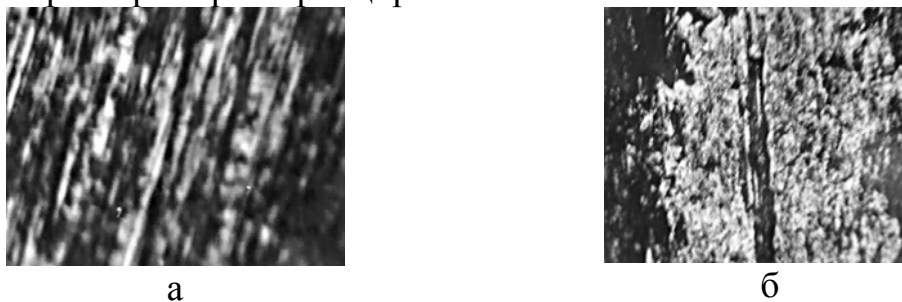
Рис. 6. Мікрорельєф поверхня отвору корпусу (x300): а – після притирання; б – після обробки ППД.
