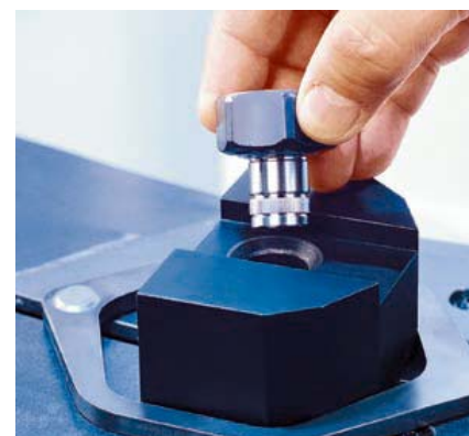
Рис. 7. Ориентация деталей в рамках транспортёра при помощи приспособлений.
