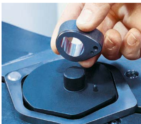
Рис. 7. Ориентация деталей в рамках транспортёра при помощи приспособлений.
