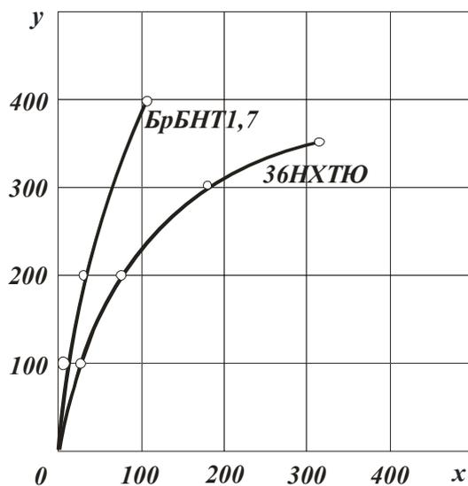
Рис. 2. Зависимость прогиба штанги от её длины для штанг из сплава марки: 1 – БрБНТ 1,7; 2 – 36НХТЮ.
