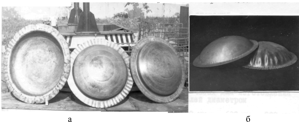
Рис. 1. Детали диаметром 700 и 900 мм (а) и опытные образцы (б), отштампованные методом штамповки-раздачи
