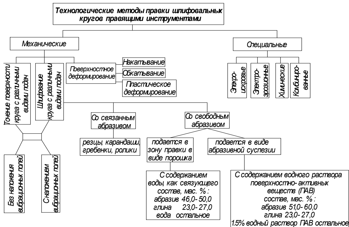
Рис.1 Технологические методы правки шлифовальных кругов.
