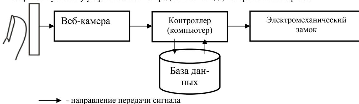
Рис.1. Схема взаимодействия основных блоков устройства.
