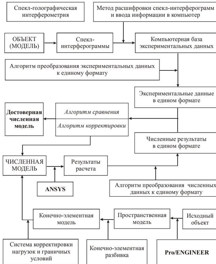
Рис. 5. Взаимодействие модулей созданного СПАК на базе метода конечных элементов и спекл-голографической интерферометрии.
