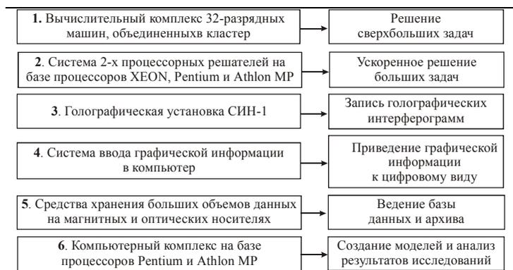
Рис. 7. Состав и функции элементов аппаратного обеспечения программно-аппаратного комплекса.
