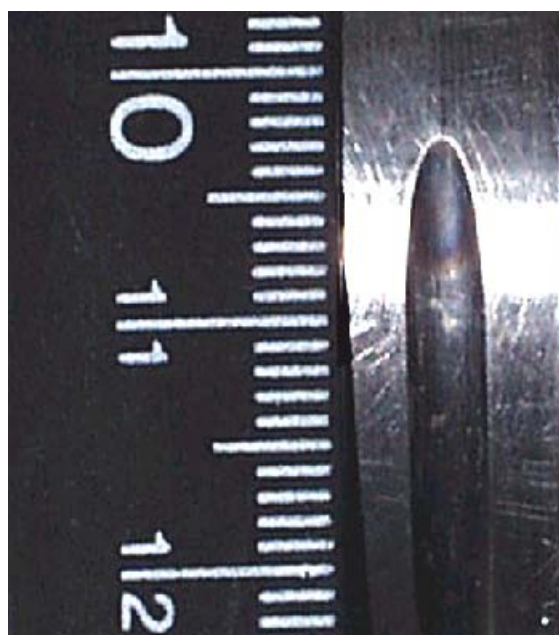
Рис.4 Пятно контакта шлифовального круга с заготовкой на первом переходе (результат шлифования).
