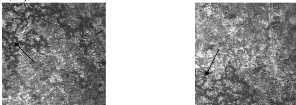
Рис. 2. Поры в чугуне гильзы, \times 100 .
