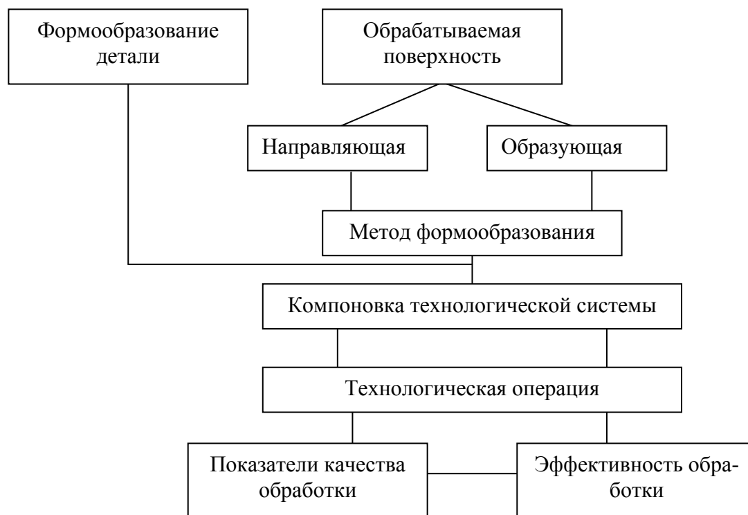
Рис. 1. Схема связи факторов формообразования и показателей качества и эффективности обработки деталей при формировании технологической операции.
