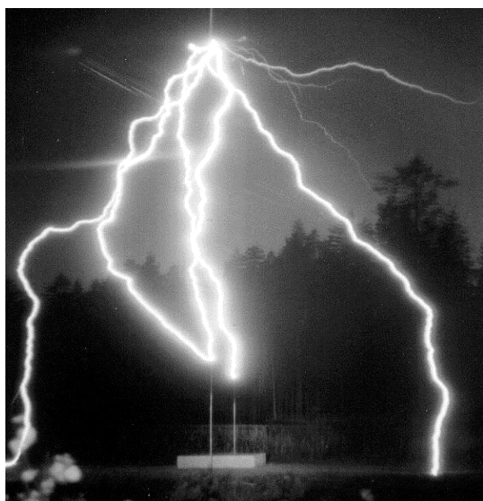
Рис. 1. Серия из пяти разрядов в воздушном промежутке s=15\text{м} при испытании молниеотводов высотой 3,2м.
