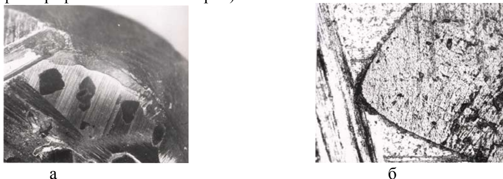
Рис.2. Рабочая поверхность алмазного правящего карандаша (темные участки на фотографии а – алмазные зерна; на фотографии б показано алмазное зерно в увеличенном масштабе).
