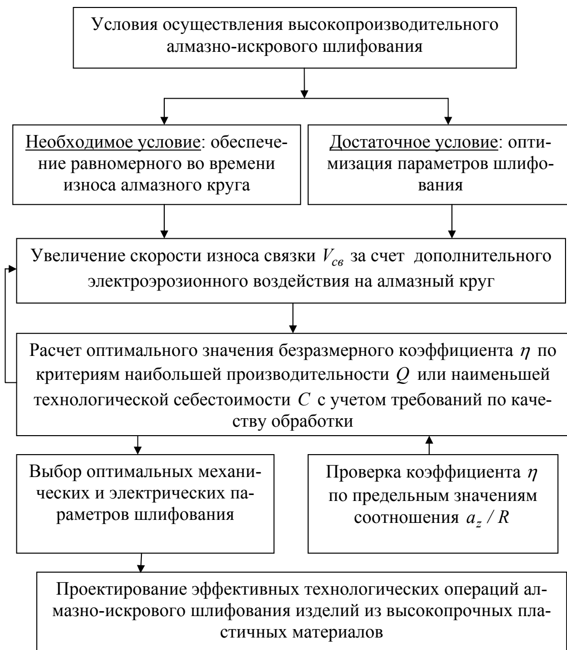
Рис. 7. Структурная схема выбора оптимальных условий алмазно-искрового шлифования.
