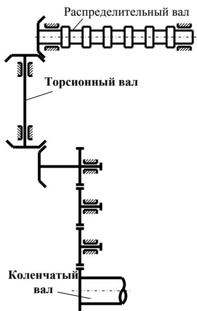
Рис. 1. Кинематическая схема привода.
