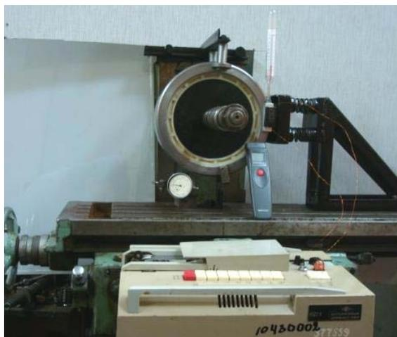
Рис. 1. Пристрій для модельних випробувань трибоспряження “сепаратор – базуюче” кільце підшипників.
