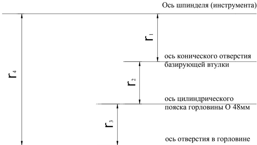
Рис. 10. Размерная цепь отклонений от соосности на четвёртой позиции.
