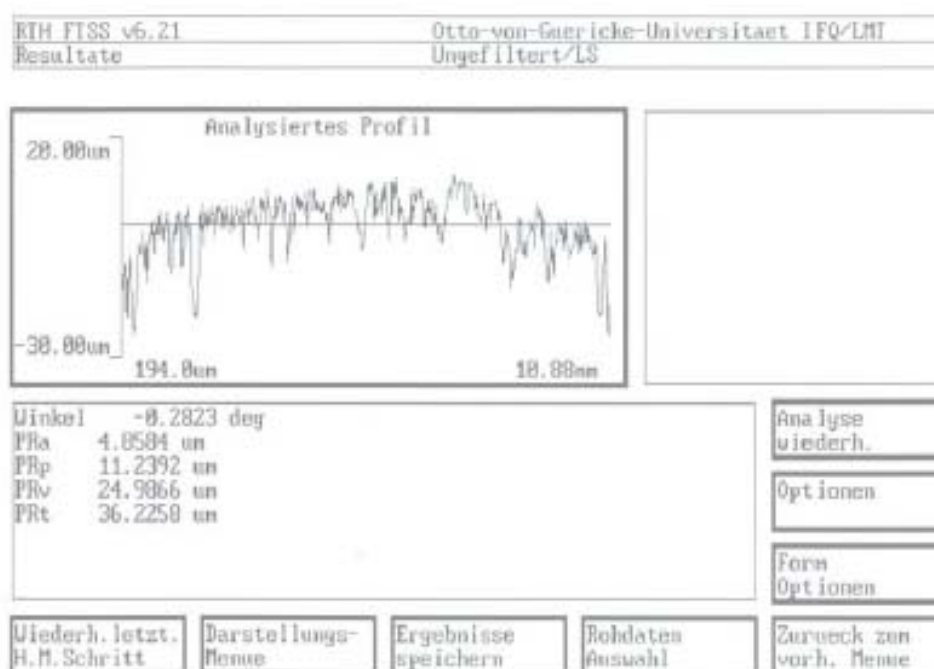
Рисунок 3 – Профилограммы шероховатости режущей кромки а – твердый сплав «ВолКар», б – твердый сплав ВК6. круг 12A2-45° AC6 100/80 M1-01; P_H = 1,2 \text{ МПа} , V = 25 \text{ м/с} .
