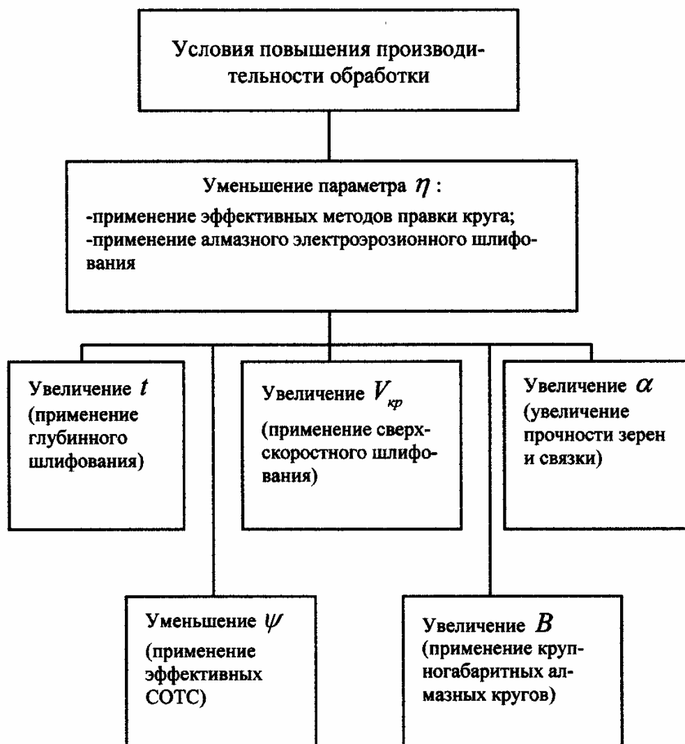
Рис. 1. Структурная схема условий повышения производительности шлифования.
