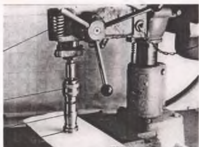
Рис. 5. Приспособление для снятия фасок на кромках торцовых поверхностей релитовых колец, установленная на настольно-сверлильном станке: 1 – настольно-сверлильный станок; 2 – патрон; 3 – приспособление; 4 – невращающееся кольцо.
