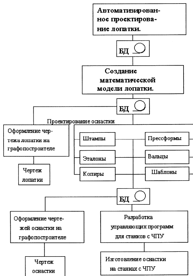
Рис.1. Комплексная САПР технологической оснастки для производства лопаток.
