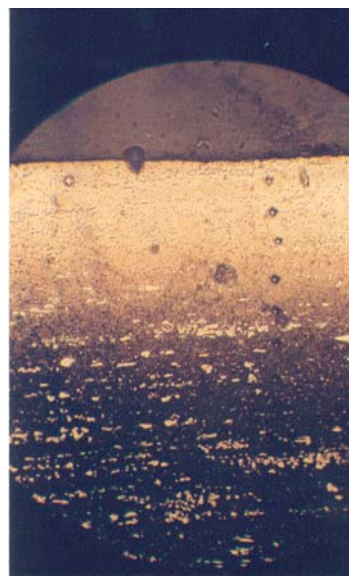
Рис.2. Микроструктура стали X12M в исходном состоянии после ТФО.
