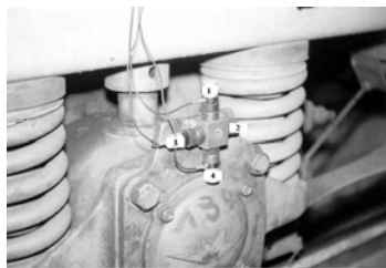
Рис. 1. Буксовый узел КРБ электропоезда серии ЕЖ-3 с установленными на нем вибродатчиками: датчики № 1, 4 – вертикальное направление; датчики № 2, 3 – поперечное направление.
