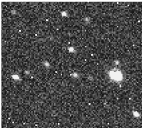
Рисунок 4 –Аномальные пиксели на цифровом кадре.
