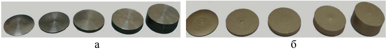
Рисунок 37 – Зразки з латуні ЛС59.1 у формі диска діаметром 20 мм і товщиною 0,5; 1; 2; 4 і 8 мм до обробки (а) і після обробки (б)
