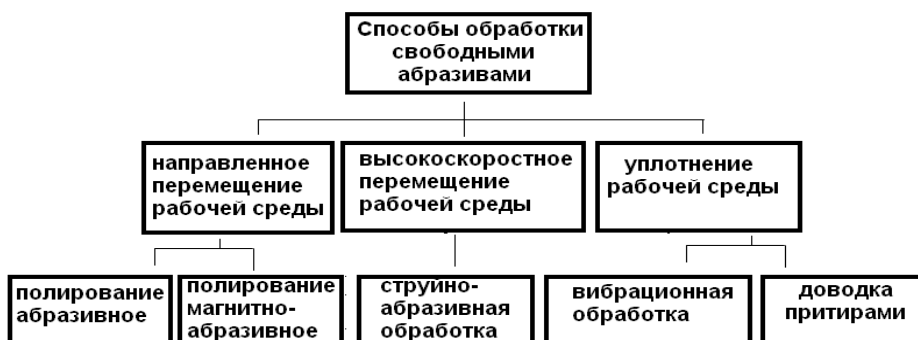
Рис. 5 – Классификация способов обработки свободными абразивами по характеру воздействия абразивной частицы
