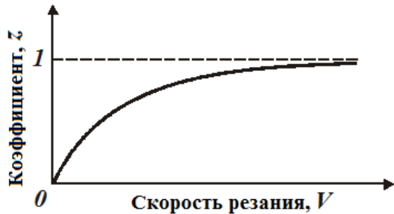
Рис. 2 – Характер изменения безразмерного коэффициента z от скорости резания V
