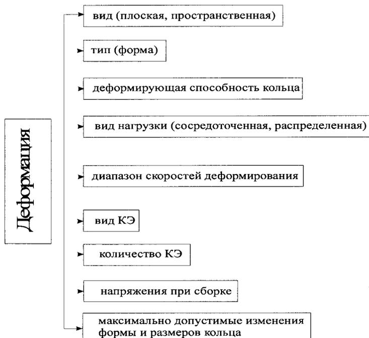
Рис. 1. Критерии описания деформаций уплотнительного кольца при установке во внутренние канавки деталей.
