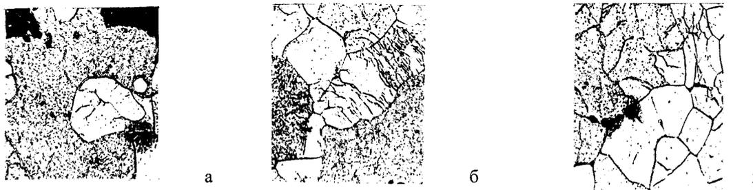
Рис.2. Рекристаллизация феррита в процессе электронагрева чугуна со скоростью  $50^{\circ}\text{C}/\text{с}$ ;  $\times 600$ : а, б -  $870^{\circ}\text{C}/\text{с}$ , в -  $920^{\circ}\text{C}/\text{с}$ .
