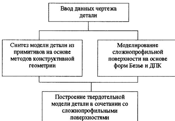
Рис. 5. Основные этапы формирования твердотельной модели детали.
