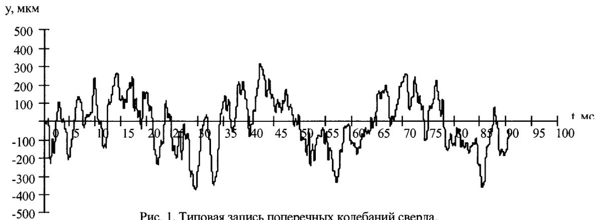
Рис. 1. Типовая запись поперечных колебаний сверла.
