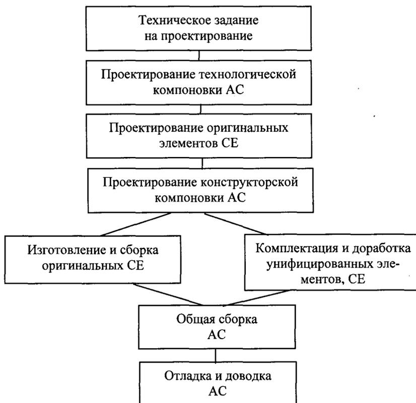
Рис. 1. Структура действующего процесса проектирования и изготовления АС.
