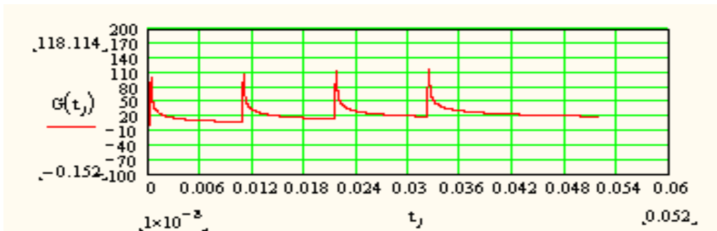
Рис.2. Расчет температуры G(t_1) на периферии диска ( x=0 ) на протяжении четырех оборотов и максимальных её значений T_{max} на каждом из оборотов.
