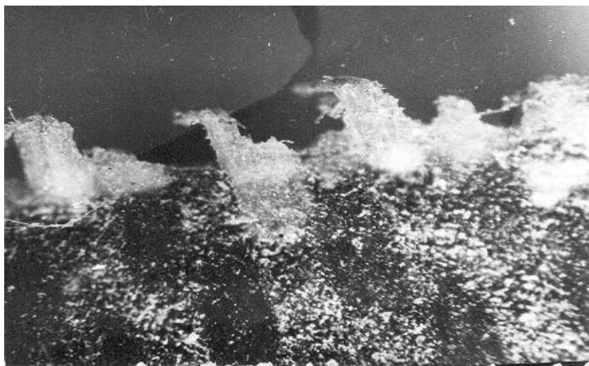
Рис. 2. Руйнування джгутів склопластика під кутом.
