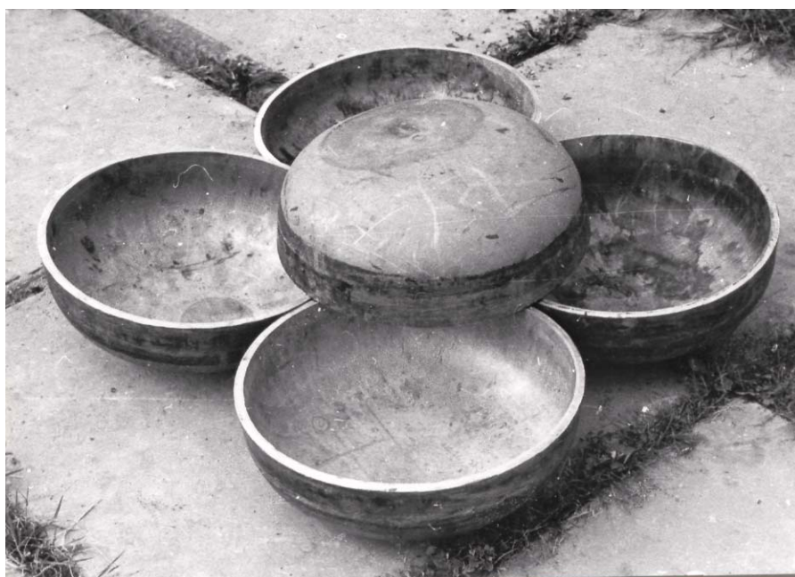
Рис.2. Детали типа «дно эллиптическое», диаметр 500мм, толщина стенки 10мм, материал 12Х18Н10Т.
