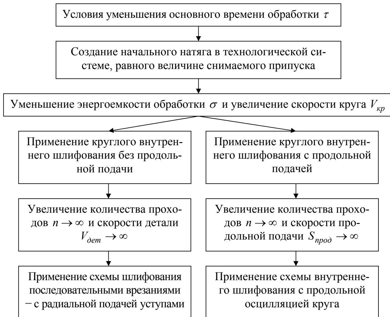
Рис. 6. Структурная схема условий уменьшения основного времени \tau при круглом внутреннем шлифовании по упругой схеме с начальным натягом в технологической системе.
