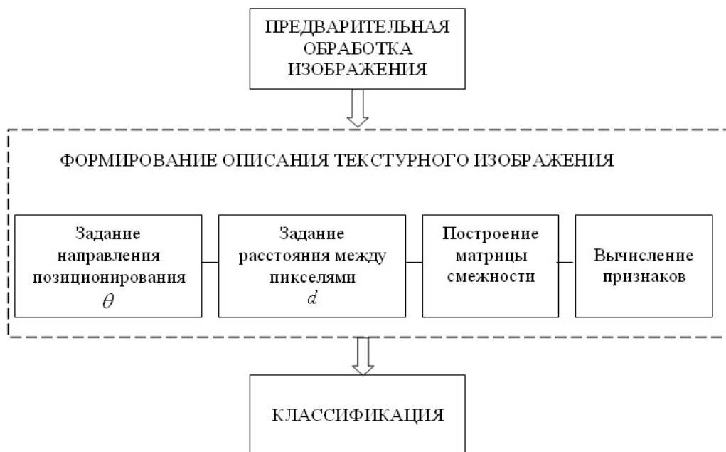
Рис. 2. Структура подсистемы ИС для распознавания текстур зон дефектов цифровых изображений режущей части.
