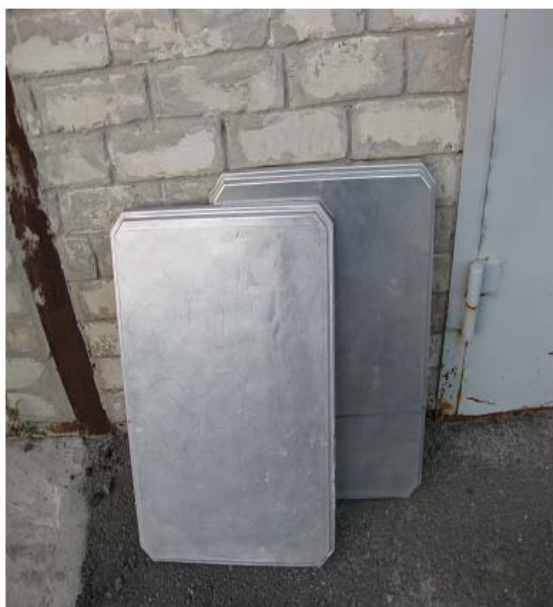
Рис. 3 – Детали коробчатой формы, отштампованные беспрессовой штамповкой
