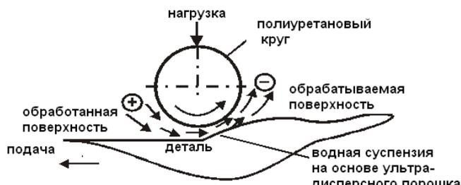
Рис. 6. Схема полирования суспензией на основе ультрадисперсного порошка
