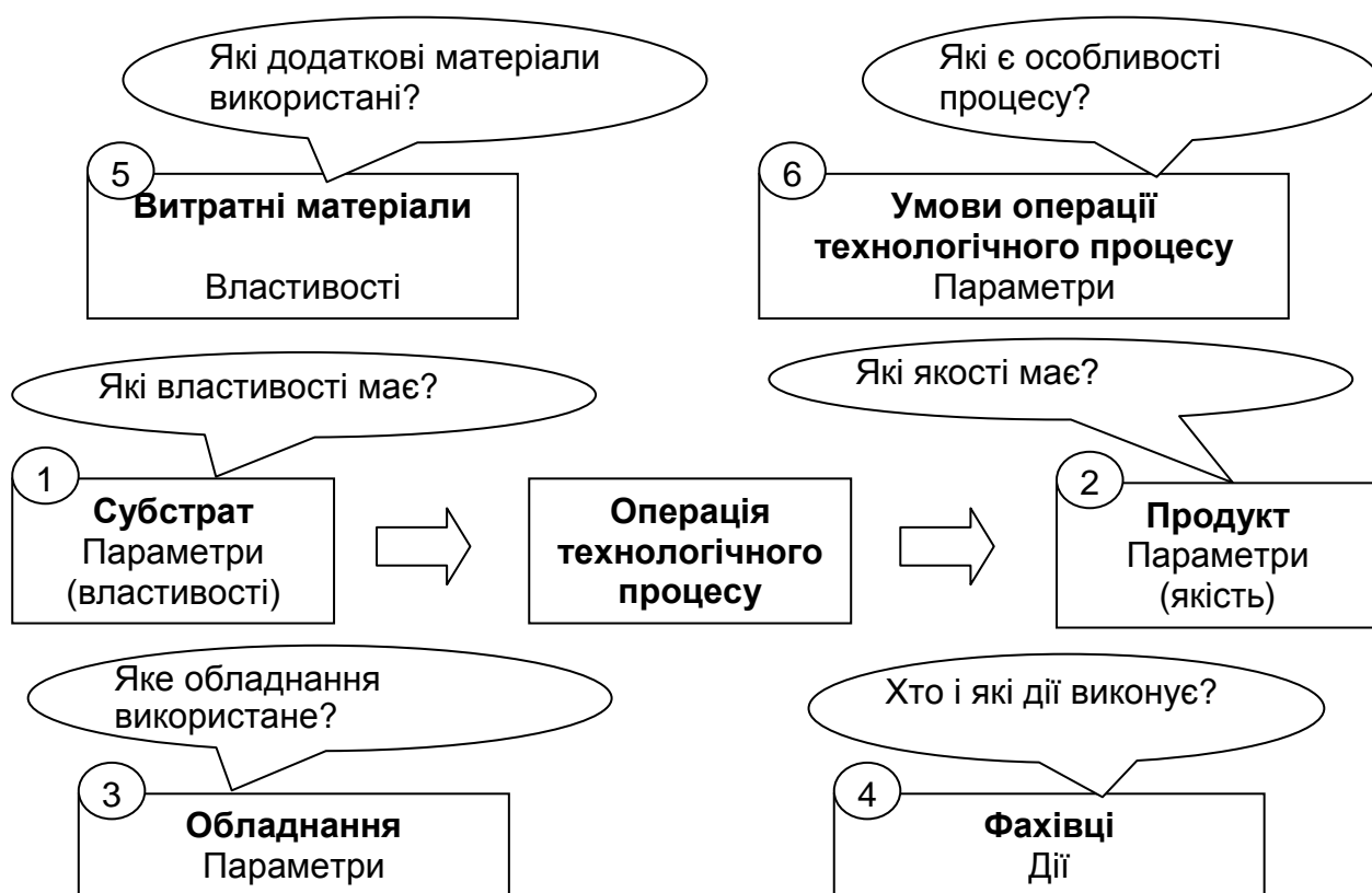
Рис. 6. Структурна схема опису окремого елемента технологічного процесу виробництва друкованого видання
