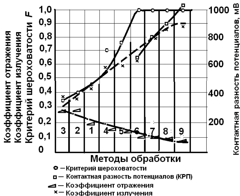
Рис. 6.15. Зависимость критерия шероховатости поверхности и КРП от методов механической обработки деталей из сплава АМг6: 1 – прокат; 2 – обработка металлической дробью; 3 – гидроабразивная обработка; 4 – фрезерование твердосплавной фрезой; 5 – фрезерование фрезой из эльбора; 6 – точение твердосплавным резцом; 7 – полирование алмазное; 8 – выглаживание; 9 – микроточение алмазным резцом
