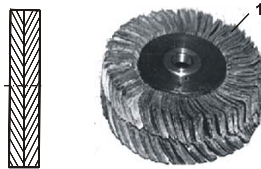
Рис. 6.4. Расположение лепестков по периферии лепесткового круга 1 повышенной жесткости
