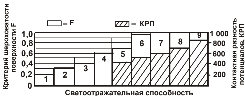
Рис. 6.19. Характер изменения светоотражательной способности и параметров поверхности от методов обработки деталей из сплава АМГ-6: 1 – прокат; 2 – гидроабразивная обработка; 3 – обработка металлической дробью; 4 – фрезерование твердосплавной фрезой; 5 – фрезерование фрезой из эльбора; 6 – точение твердосплавным резцом; 7 – алмазное полирование; 8 – выглаживание; 9 – алмазное точение
