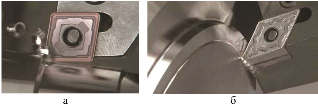
Рисунок 3. – Стружколомы EG (а) и EF (б) типов для обработки экзотических сплавов
