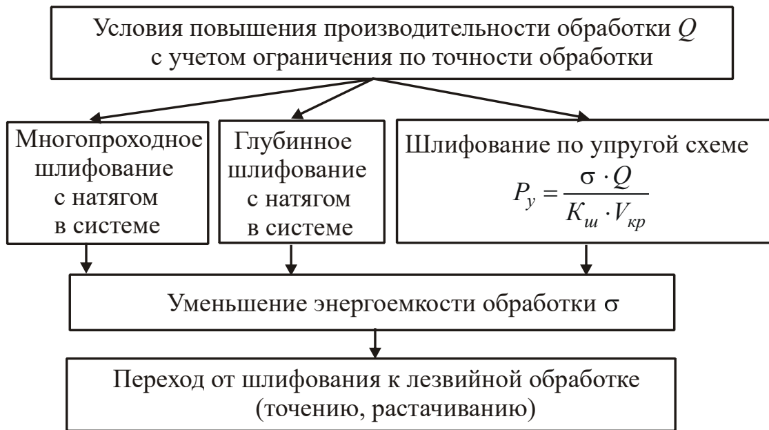
Рисунок 2 – Структурная схема условий повышения производительности обработки
