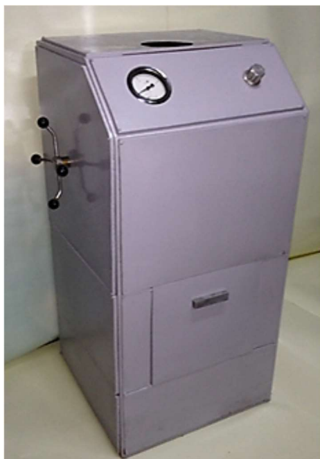
Рисунок 2. – Опытно-промышленный полуавтомат для струйно-абразивной обработки мелких деталей затопленными струями
