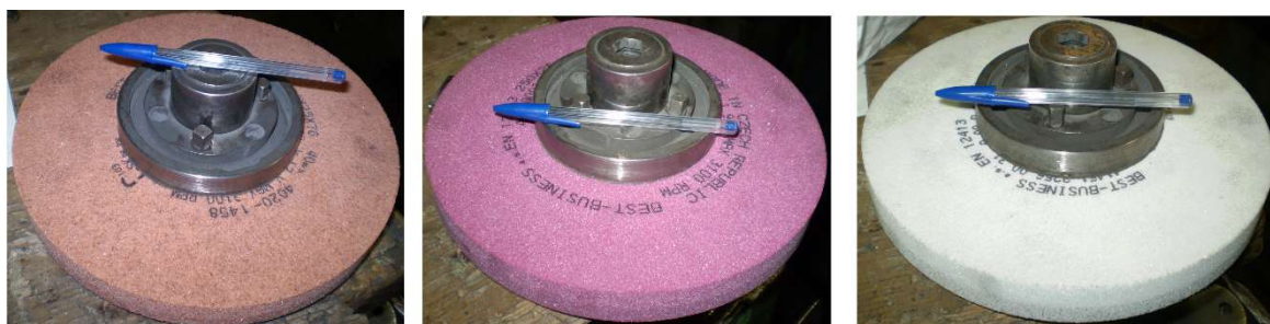
Рисунок 1. – Шліфувальні круги A9960Js12V (а), A9860I9V (б), A99B60Ks8VC40 (в)
