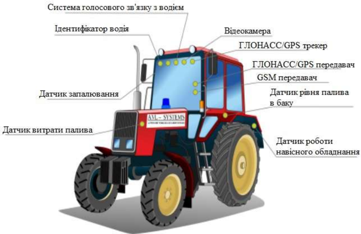
Рис. 3.5. Плановий функціонал додатку «OptiTrack v1.0» для трактору
