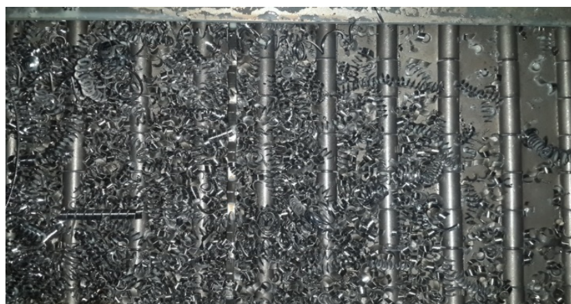
Рис. 1.34. Стружка при точении пластиной DNUX
