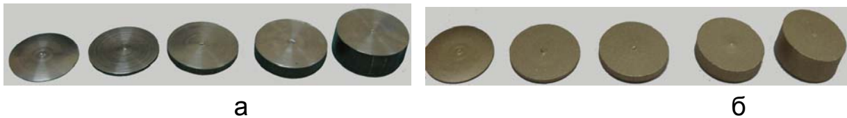
Рис. 4.37. Образцы из латуни ЛС59.1 в форме диска диаметром 20 мм и толщиной 0,5; 1; 2; 4 и 8 мм до обработки (а) и после обработки (б)
