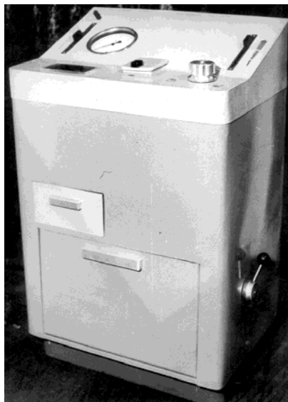
Рис. 4.52. Установка для абразивной обработки затопленными струями с пневматическим вибратором
