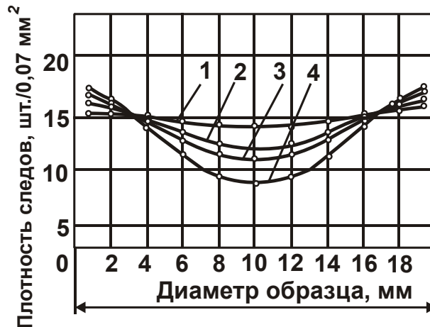
Рис. 4.38. Плотность следов абразивных зерен (в поле видимости объектива – 0,07 \text{ мм}^2 ) в диаметральной направлении образцов в форме диска:
