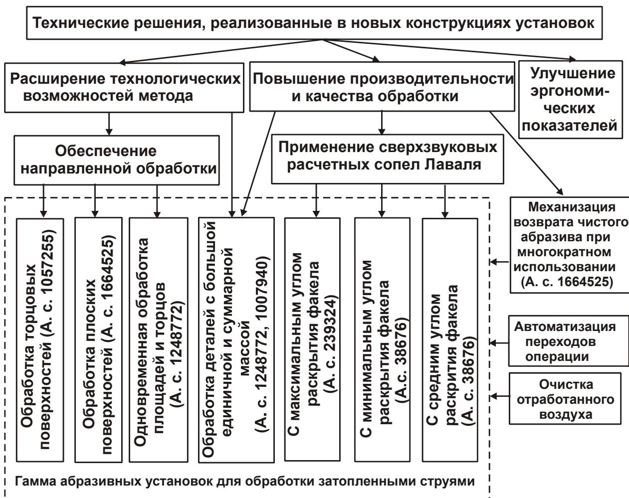
Рис. 4.40. Структурная схема технических решений, реализованных в новых конструкциях установок для осуществления абразивной обработки деталей затопленными струями
