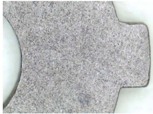
1. Фрагмент диска дверного замка, латунь Л63
