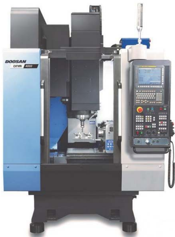
Рис. 1.1. Вертикальный обрабатывающий центр DNM 4000
