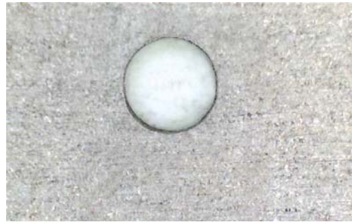
1. Фрагмент диска дверного замка, латунь Л63
