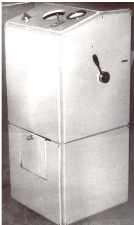
Рис. 4.65. Установка для абразивной обработки мелких деталей затопленными струями сжатого воздуха по А.с. SU №1664525 [22], А.с. SU №1057255 [17]
