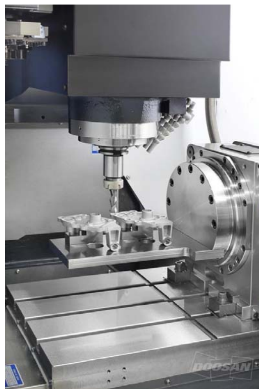
Рис. 1.1. Вертикальный обрабатывающий центр DNM 4000
