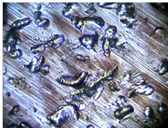
Рис. 4.27. Участок поверхности образца, ограниченный полем видимости камеры и монитора для подсчета количества следов зерен, приходящихся на единицу площади
