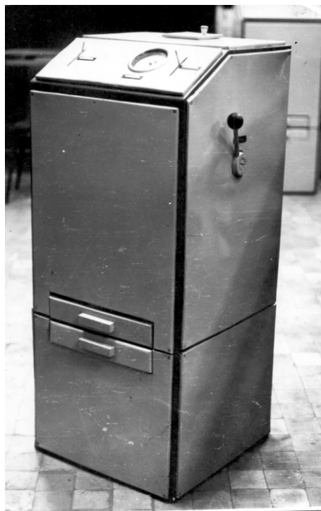
Рис. 4.66. Полуавтомат 2ГРМ для абразивной обработки затопленными струями по А.с. SU №1057255 А [17], А. с. SU №1664525 [22]
