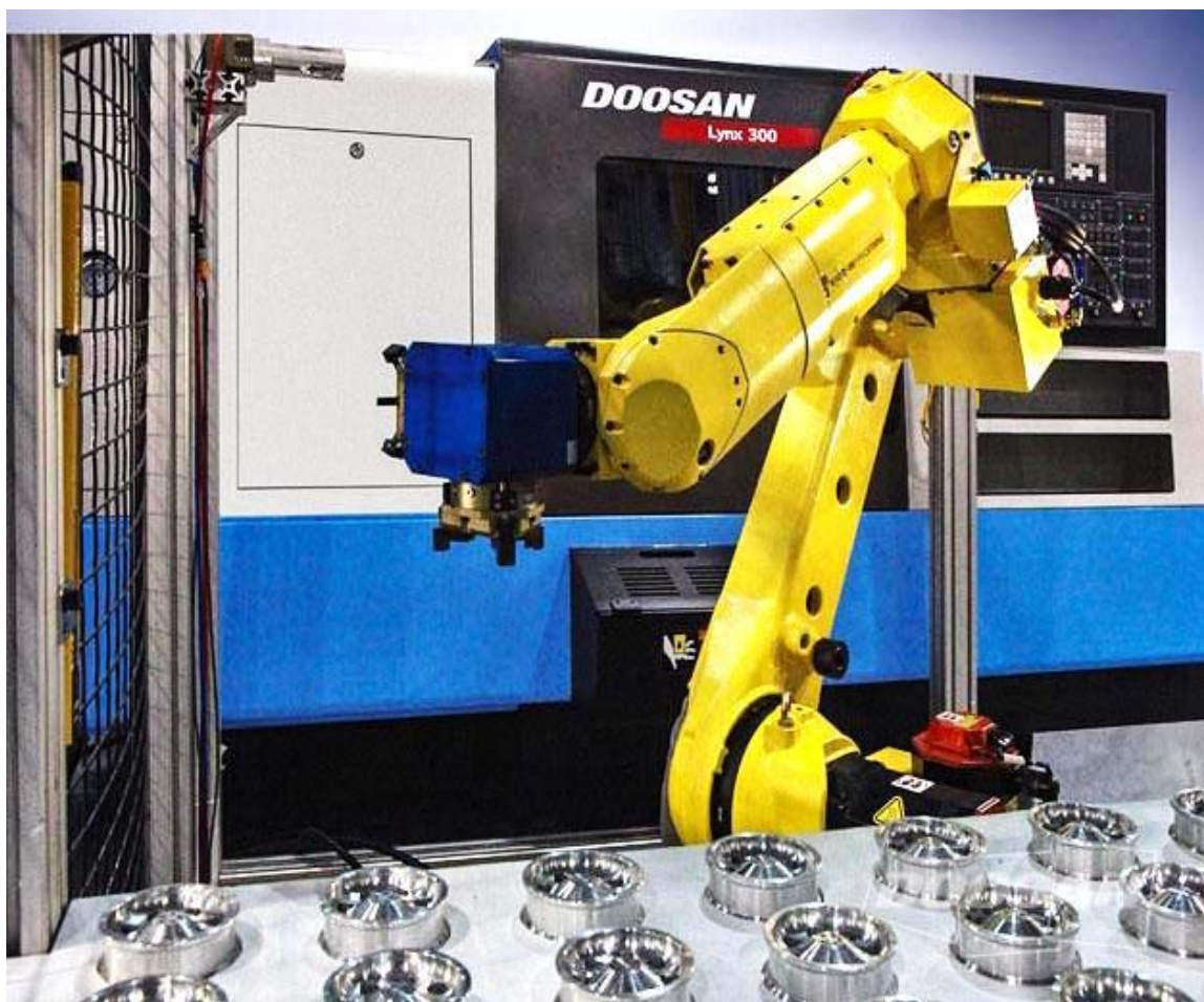
Автоматизация производства с роботом DooCell
