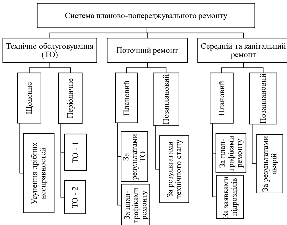
Рис. 3.1. Види ремонту обладнання на АТ «ЕЛЕКТРОМАШИНА»
