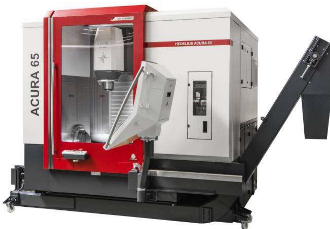
Рис. 3.3. Фрезерно-обробний центр HEDELIOUS ACURA 65 [69]
