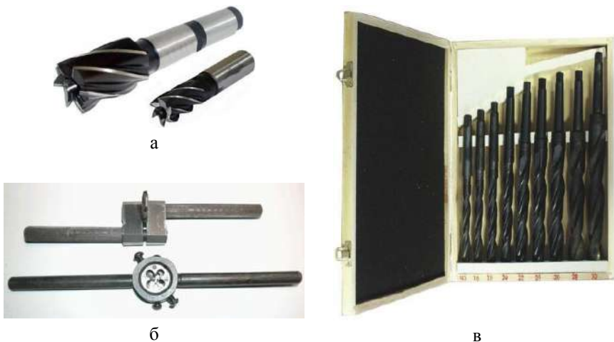
Рисунок 5.50 – Застосовувані ріжучі інструменти: кінцеві фрези (а), мітчик і плашка (б), свердла (в)
