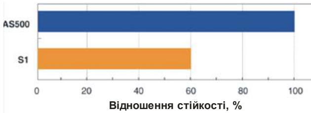
Рисунок 1.37 – Чорнове точіння валків (HS50): \varnothing 313 мм; V = 50 м/хв; f = 0,5 мм/об.; глибина різання 26 мм; без охолоджувальної рідини. Пластина LNU6688T, AS500 (TaeguTec), S1 (Конкурент)
