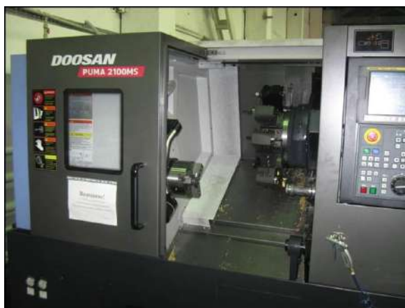
Рисунок 5.18 – Високопродуктивний двошпindelний токарний обробний центр PUMA 2100MS із приводним фрезерним інструментом і контр-шпинделем ("DOOSAN")
