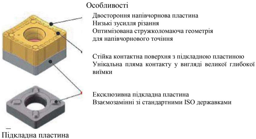
Рисунок 1.11 – Особливості пластин із стружкоруйнуючою геометрією НВ
