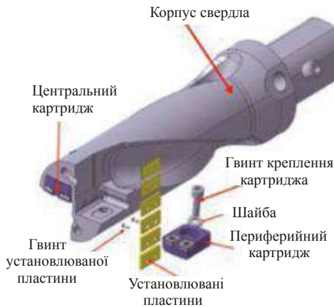
Рисунок 1.21 – Свердло серії T-Drill із картриджами
