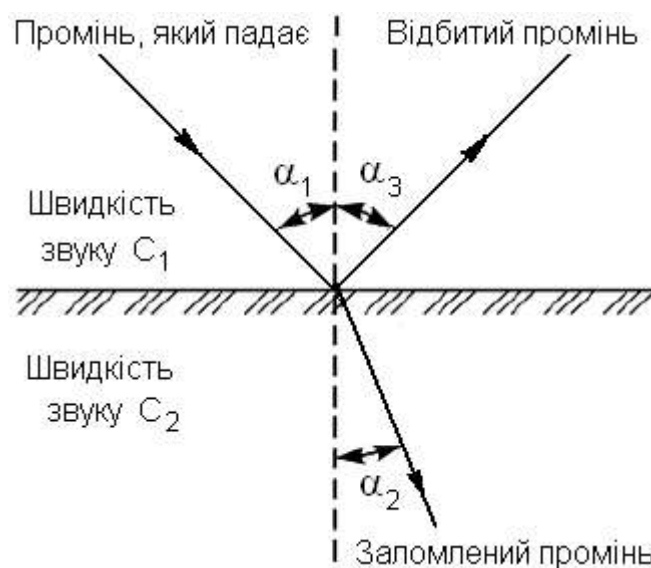
Рис. 5.1. Відбивання й заломлення звукової хвилі на межі розподілу двох середовищ
