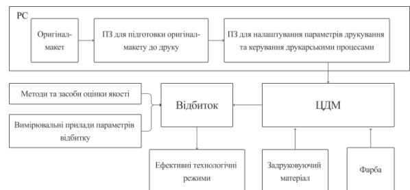
Рис. 2. Інформаційна модель процесів визначення параметрів технологічного режиму закріплення відбитку цифровим способом на пористих матеріалах
