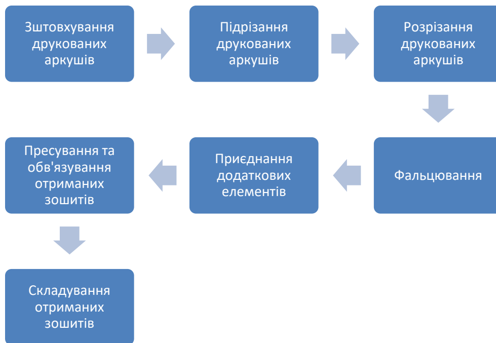
Рис. 5.1. Схема виготовлення зошитів із раніше надрукованих аркушів
