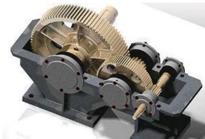
Рисунок 10.35 – Одноступінчастий (а) та двоступінчастий (б) циліндричні редуктори
