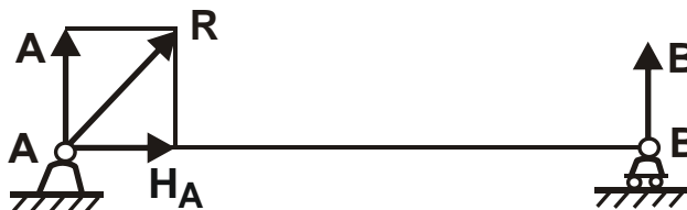
Рисунок 9.2 – Напрями реакцій шарнірно-нерухомої та шарнірно-рухомої опори
