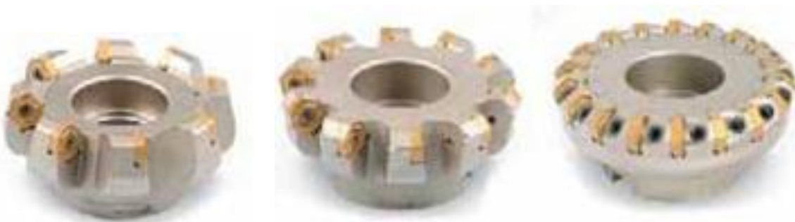
Рисунок 12.9 – Сучасні закордонні металорізальні інструменти зі зносостійкими покриттями
