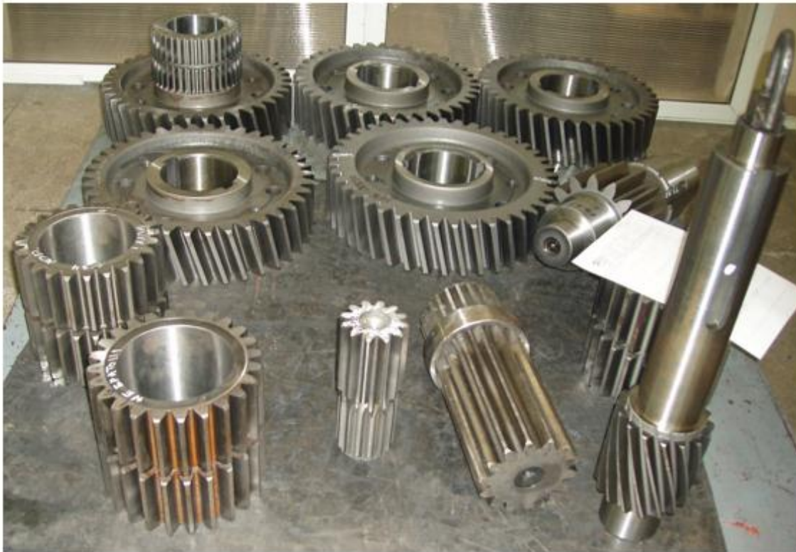
Рисунок 10.5 – Зубчасті колеса, зубчасті вали і сателіти редукторів
