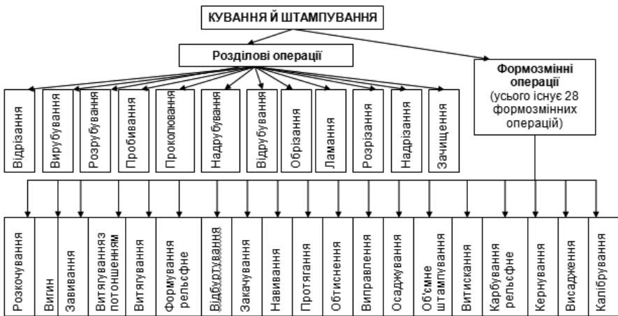
Рисунок 7.12 – Класифікація основних операцій, які застосовують під час кування і штампування
