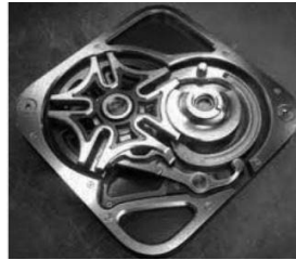
Рисунок 2.7 – Мальтійський механізм: 1 – ведучий диск (кривошип); 2 – ведений диск (хрест); 3 – станина
