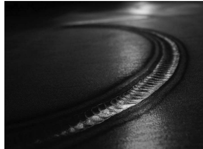
Рисунок 2.21 – Процес зварювання з'єднань та вигляд зварювального з'єднання
