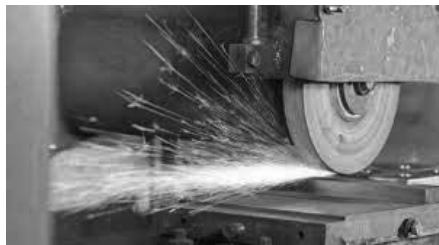
Рисунок 9.8 – Плоскошліфувальний верстат Bernardo BSG 50160 PLC (05-1452XL) (а) і зона обробки в умовах плоского шліфування (б)
