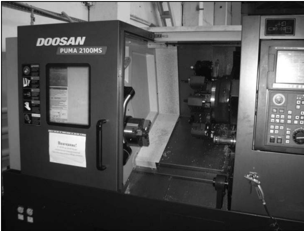
Рисунок 15.3 – Високопродуктивний двошпindelний токарний обробний центр PUMA 2100MS із приводним фрезерним інструментом і контр-шпindelем ("DOOSAN")
