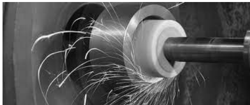
Рисунок 9.9 – Зона обробки в умовах внутрішнього шліфування
