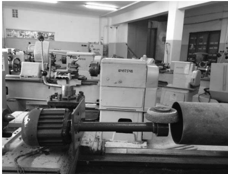
Рисунок 1.23 – Схема обробки шліфуванням отвору в циліндрі
