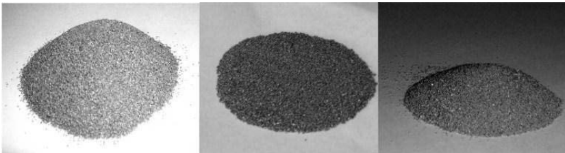
Рисунок 7.9 – Газорозпилені порошки жароміцних сплавів на нікелевій основі
