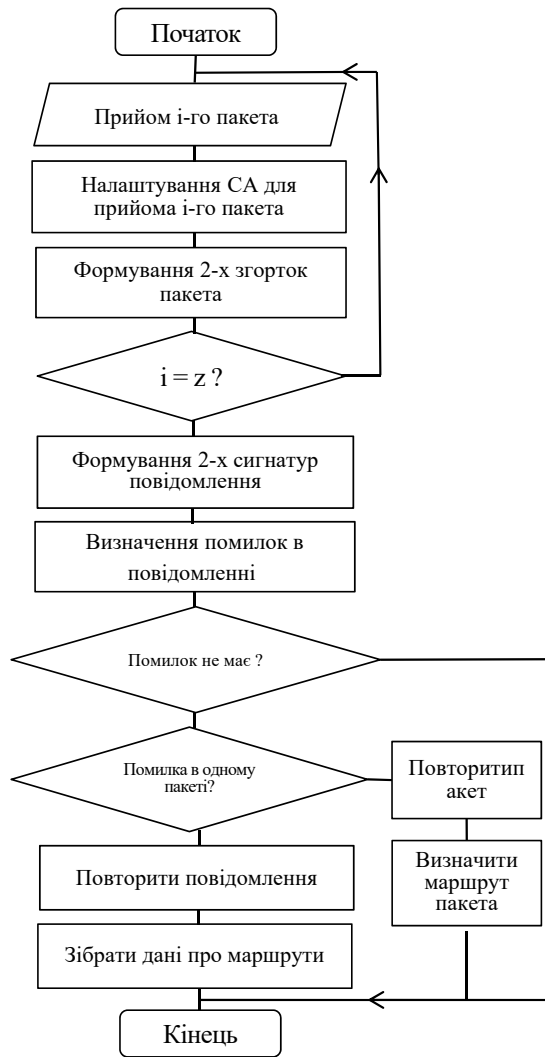
Рисунок 1. Алгоритм обробки повідомлення
