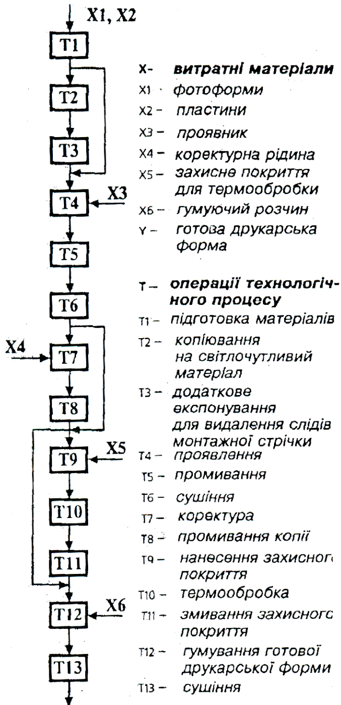
Рис. 1. Технологічний процес виготовлення друкарської форми [ 2 ]
