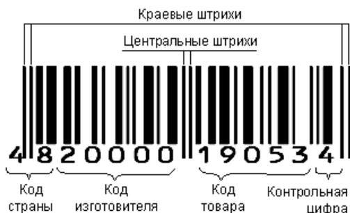
Рис. 2. Структура штрихового кода EAN-13
