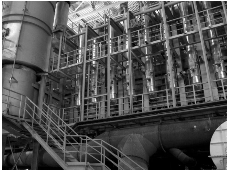
Рис. 1. Піч для виготовлення вихідної маси для виготовлення виробів зі скла
