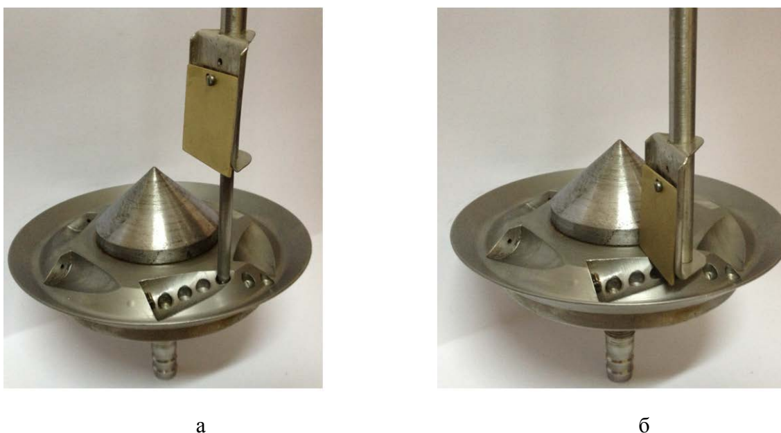
Рис. 1 – Внешний вид устройства для установки экрана перед соплом завихрителя на период, равный 5-ти секундам: а – положение над соплом (вне струи); б – перед соплом (в зоне действия струи)
