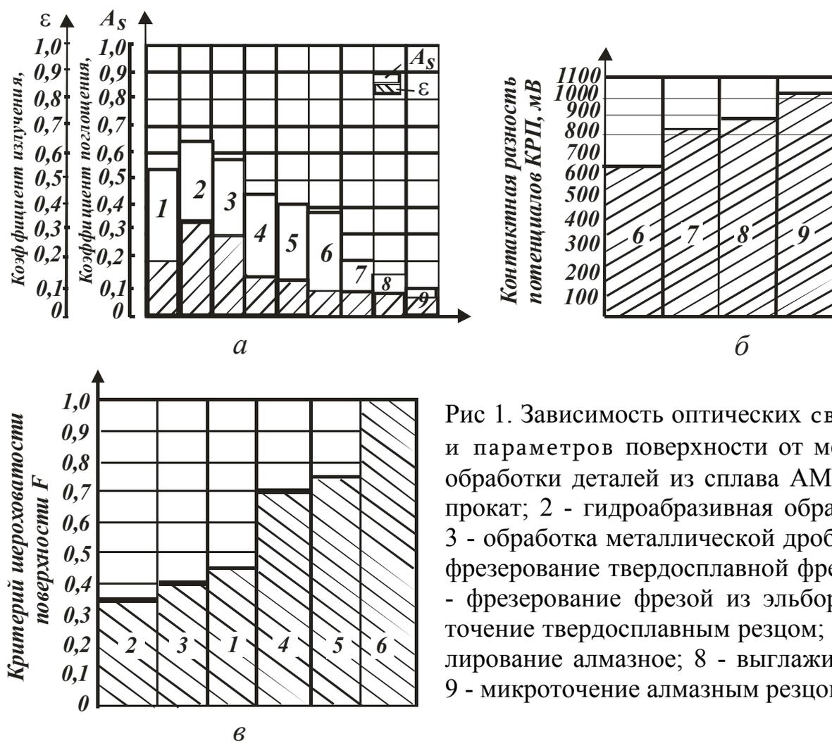
Рис 1. Зависимость оптических свойств и параметров поверхности от методов обработки деталей из сплава АМгб: 1 - прокат; 2 - гидроабразивная обработка; 3 - обработка металлической дробью; 4- фрезерование твердосплавной фрезой; 5 - фрезерование фрезой из эльбора; 6 - точение твердосплавным резцом; 7 - полирование алмазное; 8 - выглаживание, 9 - микроточение алмазным резцом.
