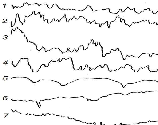
Рис. 3. Профилограммы поверхности образцов из сплава АМг6 при различных горизонтальном (ГУ) и вертикальном (ВУ) увеличениях: 1-прокат (200 и 10000); 2-гидроабразивная обработка (200 и 4000); зуфрезерование (100 и 2000); 4- точение твердым сплавом (400 и 10000); 5-абразивное полирование (200 и 10000); 6-выглаживание (200 и 10000); 7-микроточение алмазом (200 и 100000).
