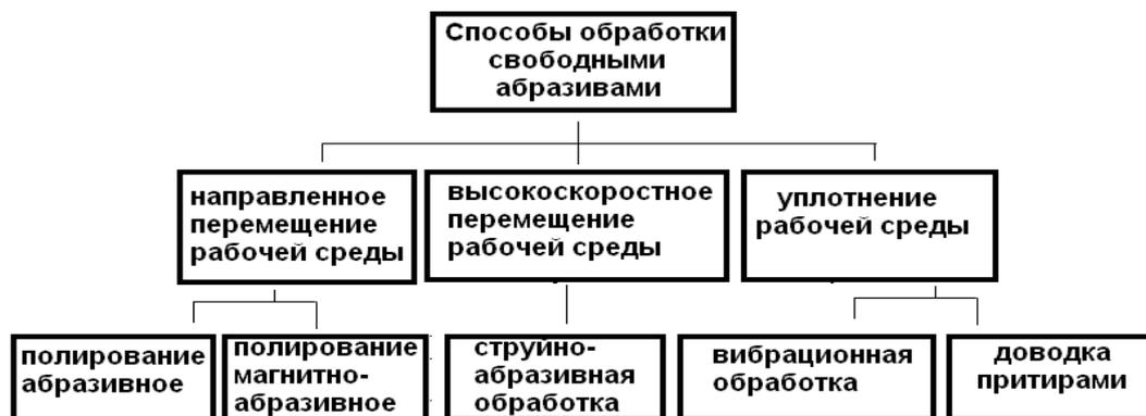
Рис.1. Классификация способов обработки свободными абразивами по характеру воздействия абразивной частицы
