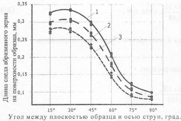
Рис. 5 – Экспериментальная зависимость длины следа абразивного зерна на поверхности полированного латунного образца от угла между его поверхностью и осью струи сжатого воздуха: 1 – зернистость абразива 630 мкм; 2 – 400 мкм; 3 – 200 мкм.
